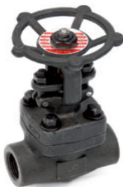
Absperrschieber ANSI Class 800 red. Durchgang, Handrad Gehäuse Schmiedestahl ASTM A105 Trim 5 = Vollstellit CE, ATEX und NACE zertifiziert
