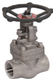
Absperrschieber ANSI Class 800 red. Durchgang, Handrad Gehäuse Edelstahl ASTM A182 F316L Trim 12 = Halbstellit CE, ATEX und NACE zertifiziert
