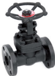
Absperrschieber ANSI Class 150 / 300 red. Durchgang, Handrad Gehäuse Schmiedestahl ASTM A105 Trim 12 = Halbstellit CE, ATEX und NACE zertifiziert
